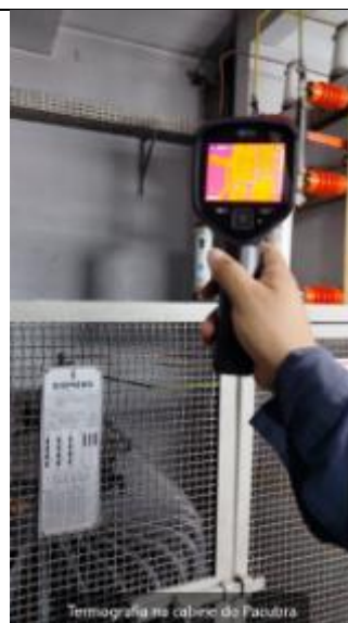
Figura 249: Análise de termografia das cabines primárias
